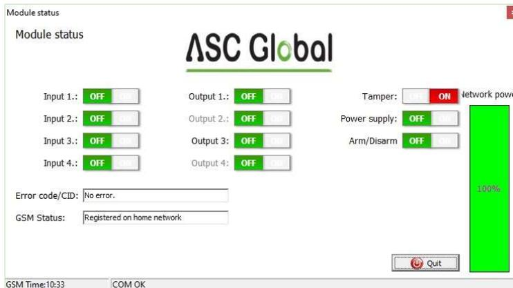
È possibile raggiungere lo stato attuale tramite il pulsante **Manutenzione** → **Mostra stato modulo**
